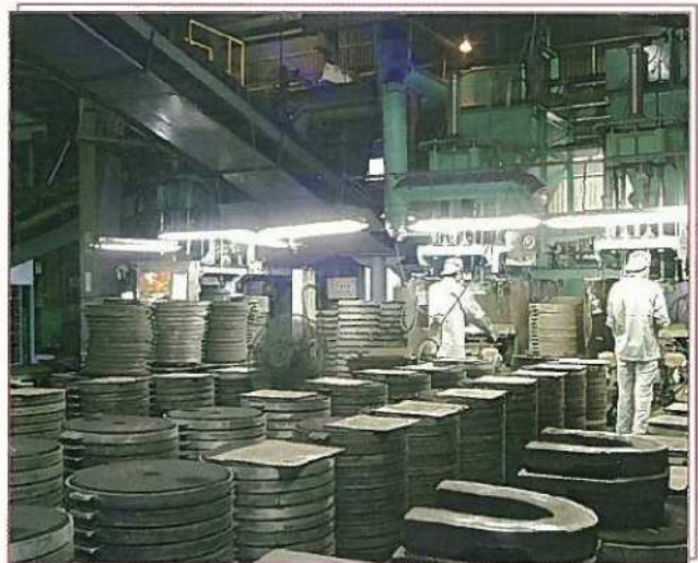
GT-500 HSD-81 生砂スタック造型製造ライン
